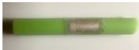
FIGURE 42 – Test (peu fructueux) d'installation d'une feuille piézo-électrique métallisée NiCu sur un poteau flexible.
