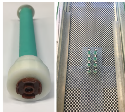
FIGURE 17 – gauche : Vue de la fixation inférieure du poteau avec une pièce Lego circulaire, droite : Installation complète des poteaux équipés dans la cuve, pour une disposition 4 \times 2 .
